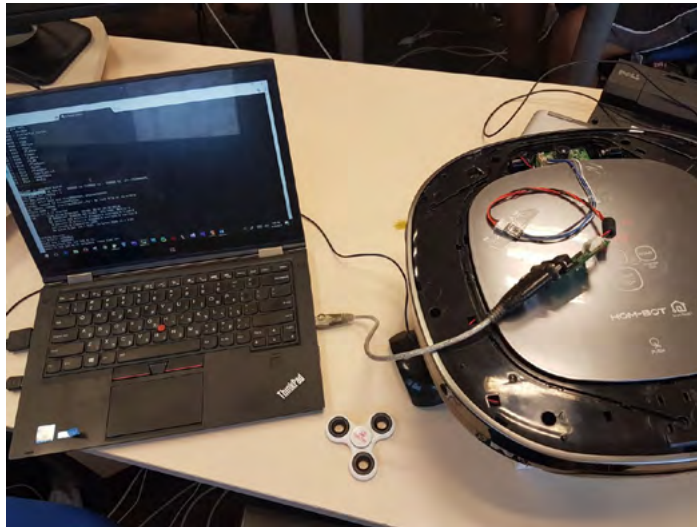
图 3.9 安全研究人员通过串口访问 LG home-bot 吸尘器的文件系统
