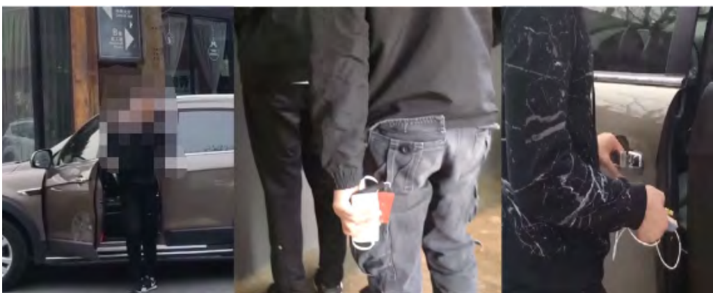
图 4.16 中间人无线信号中继开启车门
