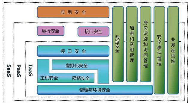
图 3.1 云计算平台安全技术体系框架
