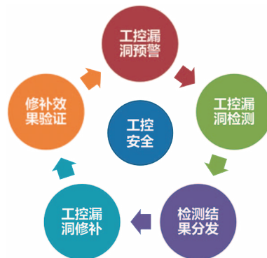
图5 工控漏洞管理流程
