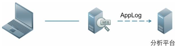
记录和保存应用程序日志可以使用 log4 开发框架，支持 Java、.Net、PHP 等多种主流语言，可以配置记录级别，输出格式和输出容器，如下图所示。
