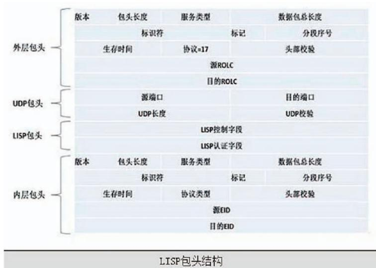
外层包头即 RLOCs, 表示离目的 EID 最近的 LISP 站点; 内层包头携带 EID 信息, 是一个非 LISP 的常规站点。
