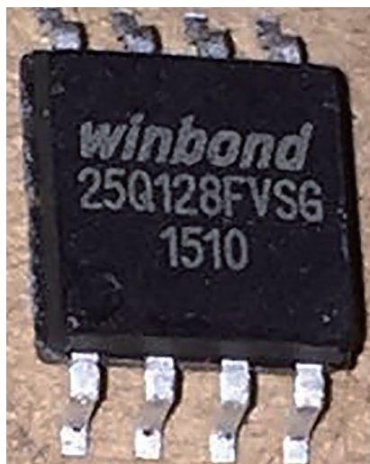
图 9--SOP8 封装的 Flash 芯片
